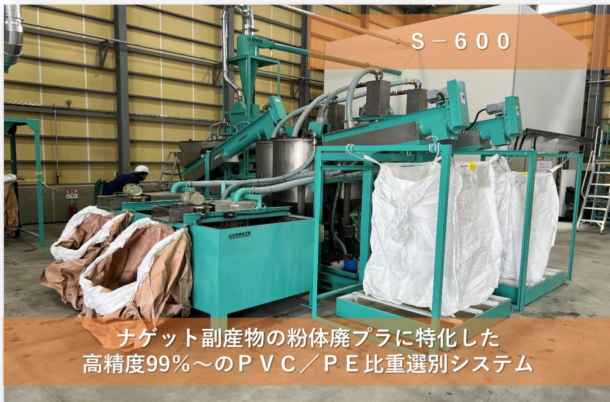
粉体廃プラを対象に重たいプラスチックと軽いプラスチックに高精度に比重選別します。主にナゲット処理の副産物であるプラスチック被覆の選別を目的に開発され、比較的粒度の小さい(3~10mm)混合廃プラに適しています。ハイドロ(液体)サイクロンを搭載し99~99.5%の高精度な比重選別を可能とし、選別後は水切り工程をへて重比重物と軽比重物に分別回収されます。廃棄物化した混合廃プラの材料リサイクルまたはサーマルリサイクルを可能とし廃棄物減量に貢献します。
