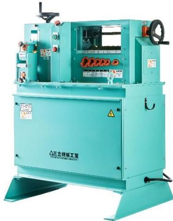
すべてのメタルリサイクラーにお勧めする業界No.1の販売台数を誇る代表モデル。一般的な電線の幅広いサイズ（22～325スクアまで）を対応可能。ターボユニットを搭載しFケーブルから多芯線、高圧線なども処理できる万能タイプの剥線機です。
