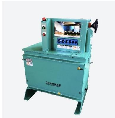
電線リサイクラーで真価を発揮するプロユースモデル。1芯ヨリ線でも60mm<sup>φ</sup>以上の太線（歩留まり80%）に対象を限定した専門性の高い機種
