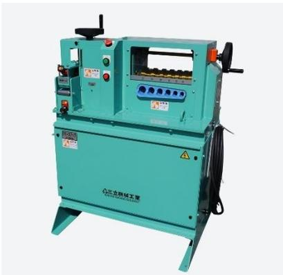
電線リサイクルを重要視する非鉄リサイクラーに推奨の太線特化モデル。多芯線外皮用のターボユニットも搭載
