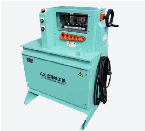
1芯ヨリ線と単線を対象としたスタンダードモデル。FケーブルやCV線を中心としたスリッターユニットのシンプルモデル
