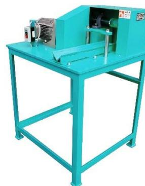
巻き残り残紙が取り除かれた紙管を対象としたシンプル機構の低価格モデルです。調整が不要で紙管を差し込むだけなので、どなたでも簡単に使用できます。
