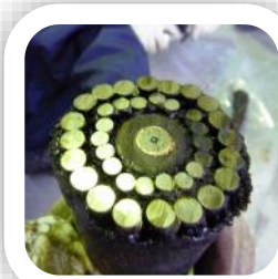
海底ケーブル
